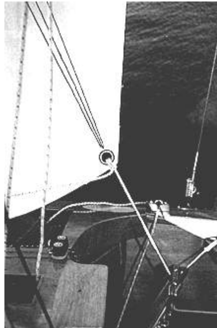
Le tacche di regolazione devono essere segnate sulle scotte del fiocco con un pennarello e così l'angolo di tiro direttamente sul fiocco
