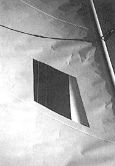
Una finestra sulla randa, posta subito sotto le crocette, permette al timoniere di tenere sempre sotto controllo il canale di uscita del fiocco.
